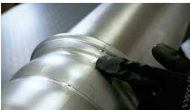
Figura 20 - Controllo visivo pressatura
