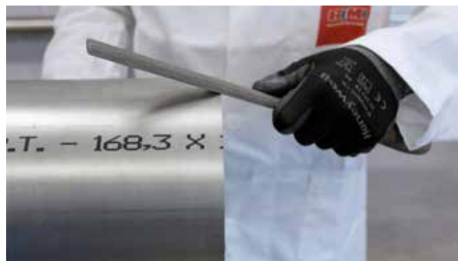
Figura 13 - Sbavatura del tubo
